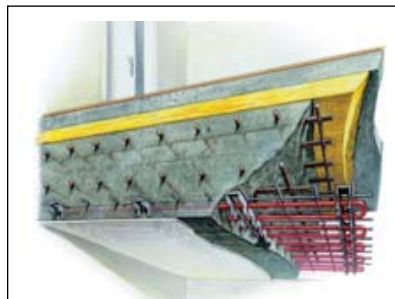
Mennyezetfűtés metszete: a csővezetékét mindössze néhány mm beton takarja, ezáltal gyorsan reagál a rendszer
