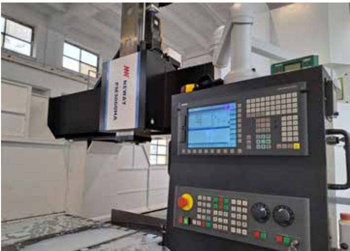
Új fejlesztés a forgóvázkeret megmunkálására alkalmas CNC vezérlésű megmunkáló központ is
